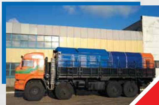
ДПН-10. «Транснефть». Насос для аварийной откачки нефти.
