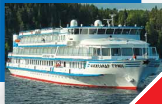
Теплоход "Александр Грин", проект Q-065/PV08. ДРРА32 x 3 ед. ДГС300 x 3 ед. Суммарная мощность 1,9 МВт.
