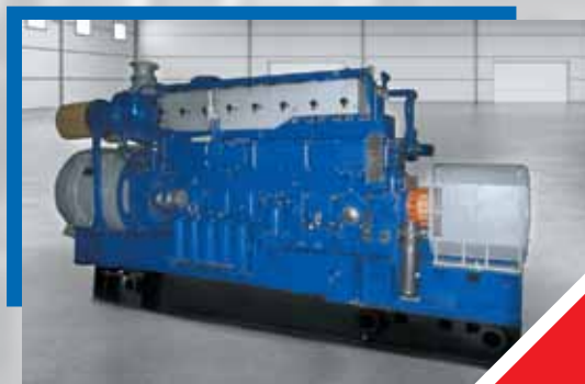
Газопоршневой силовой агрегат ГДГ800Т на сжиженном природном газе для маневрового тепловоза ТЭМ-19 мощностью 880 кВт (РЖД).
