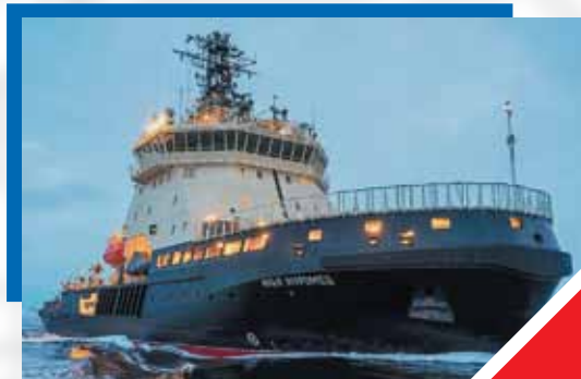
Ледокол «Илья Муромец» проекта 21180. ДГС500 x 2 ед., АДГ300С x 1 ед. Суммарная мощность 1,6 МВт.
